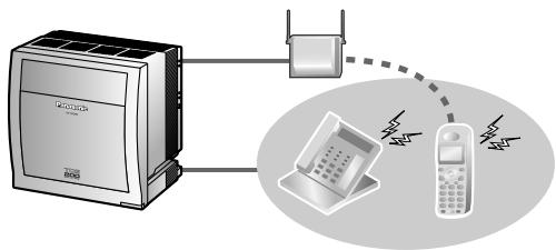
1.8.12 Подключение микросотового терминала параллельно проводному телефону (Параллельное беспроводное XDP-подключение) (Стр. 155)
