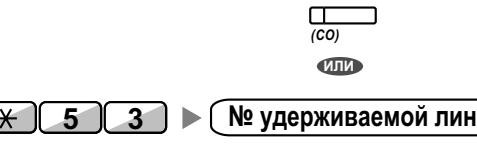
Поднимите трубку. Нажмите кнопку **CO** или наберите **\* 53** и затем наберите **номер удерживаемой линии** (3 цифры). Прослушивается тональный сигнал подтверждения.
