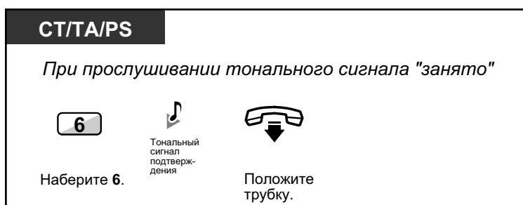
**Ответ при прослушивании вызывного сигнала обратного вызова**
