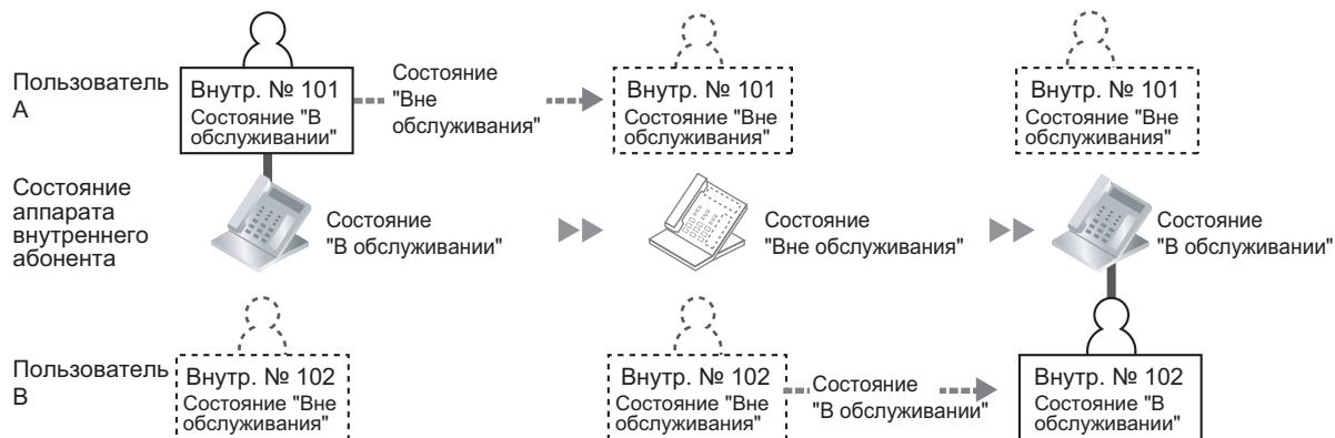
В этом примере внутренние абоненты А и В работают посменно и по очереди пользуются одним и тем же телефонным аппаратом. По завершении работы пользователь А устанавливает для аппарата внутреннего абонента состояние "Вне обслуживания". Затем пользователь В может установить для аппарата внутреннего абонента состояние "В обслуживании", в результате чего на этом аппарате будут доступны его собственные настройки.
