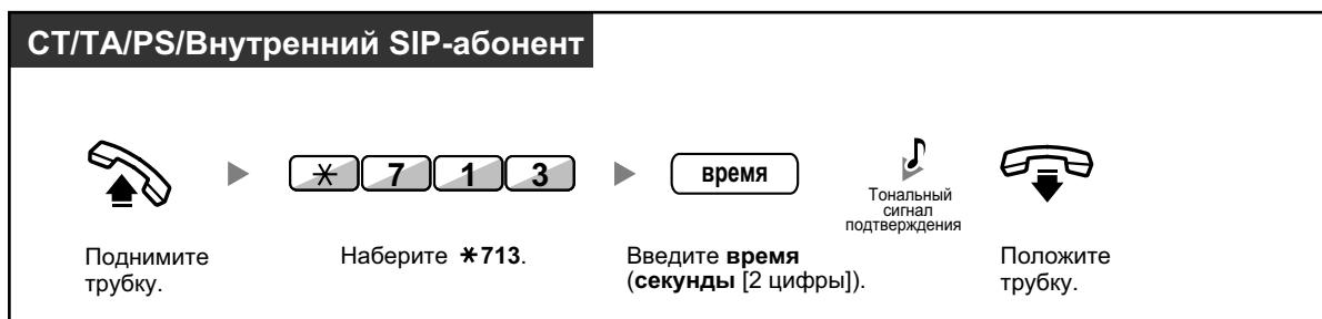
**Установка/отмена (Постоянная переадресация вызовов [FWD] для группы распределения входящих вызовов)**
