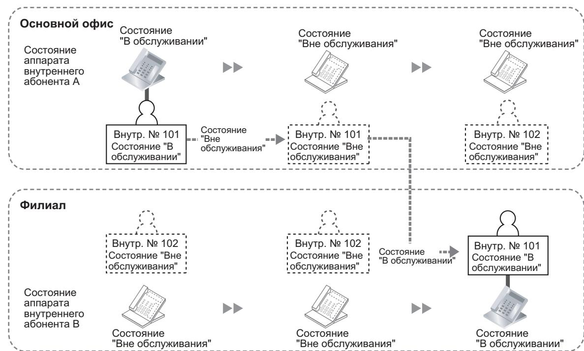
В этом примере внутренний абонент А устанавливает для своего аппарата внутреннего абонента в главном офисе состояние "Вне обслуживания". Затем он может перевести другой аппарат внутреннего абонента в филиале в состояние "В обслуживании", в результате чего на нем будут доступны требуемые настройки внутреннего абонента.
