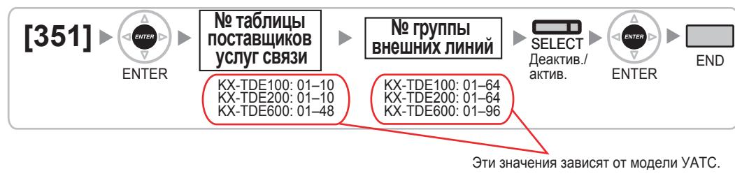
Однако следует отметить, что значения ввода для слотов и портов для каждого параметра программирования не указаны. Эти значения изменяются в зависимости от модели УАТС и типа установленной платы (см. ниже).
